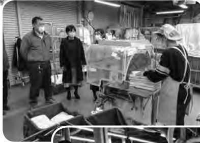
▲イレクターを活用してスムーズにリネンをローラーに投入できます。
