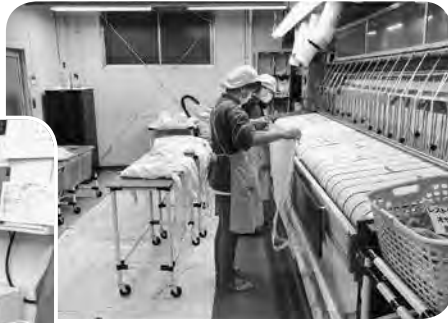
▲イレクターを活用してスムーズにリネンをローラーに投入できます。
