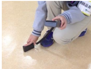
床の平滑度を数値化する『光沢度 2 測定』で汚染を除去しやすい床を維持！
