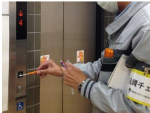
環境表面の清浄度を数値化する『ATP 1 測定』で清拭の徹底具合を確認します。
