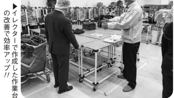
▶イレクターで作成した作業台の改善で効率アップ!!
